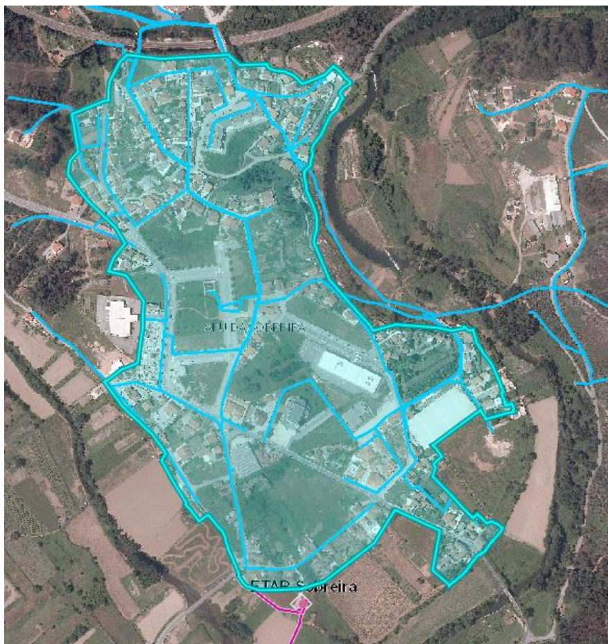
Figura 7 – Rede de Abastecimento de água
