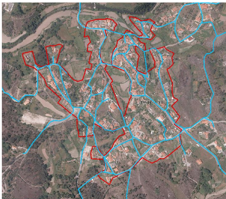
Figura 7 – Rede de Abastecimento de água
