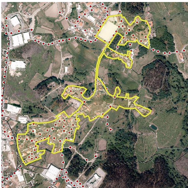
Figura 8 - Infraestruturas de iluminação pública (cobertura aerofotográfica de maio de 2017)
