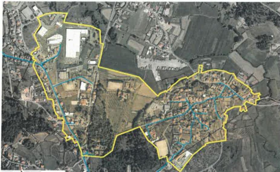
Figura 7 - Rede de abastecimento de água (cobertura aerofotográfica de 2021). Fonte: SIGAP
