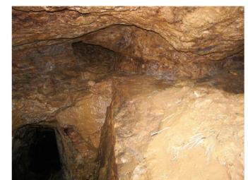
Desmonte mineiro subterrâneo em que a sustentação do tecto é garantida por um pilar com fraca mineralização.
