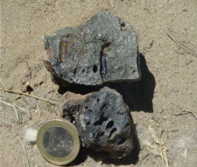
Em Castromil elas são essencialmente de dois tipos: siliciosas e com vesículas de escape de gases (esquerda); ligas maciças à base de ferro e arsénio (direita, foto ao microscópio de reflexão)
