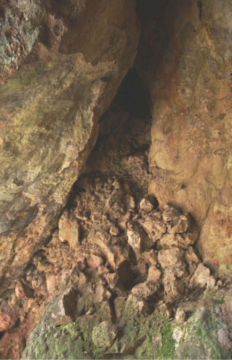
Material mineralizado fragmentado mas cujo baixo teor em ouro não deve ter justificado o finalizar do seu tratamento
